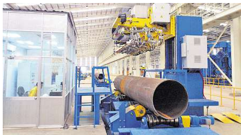
Nordinkraft ist Marktführer in Asien: Ein System zur Prüfung von Rohren ist auch in Go Cong Dong (Vietnam) im Einsatz. FOTOS: PRIVAT
