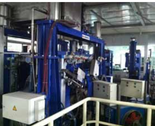
Установка для контроля сортовой заготовки диаметром 80–560 мм. TISCO, Китай, 2012 год
