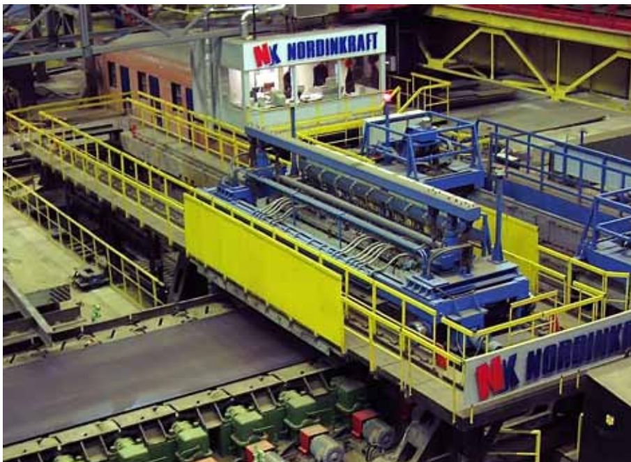
Первая в мире установка для бесконтактного автоматического ультразвукового контроля листового проката с температурой до +650 °С «Север 6-08-5000». Колпино, 2002 год
