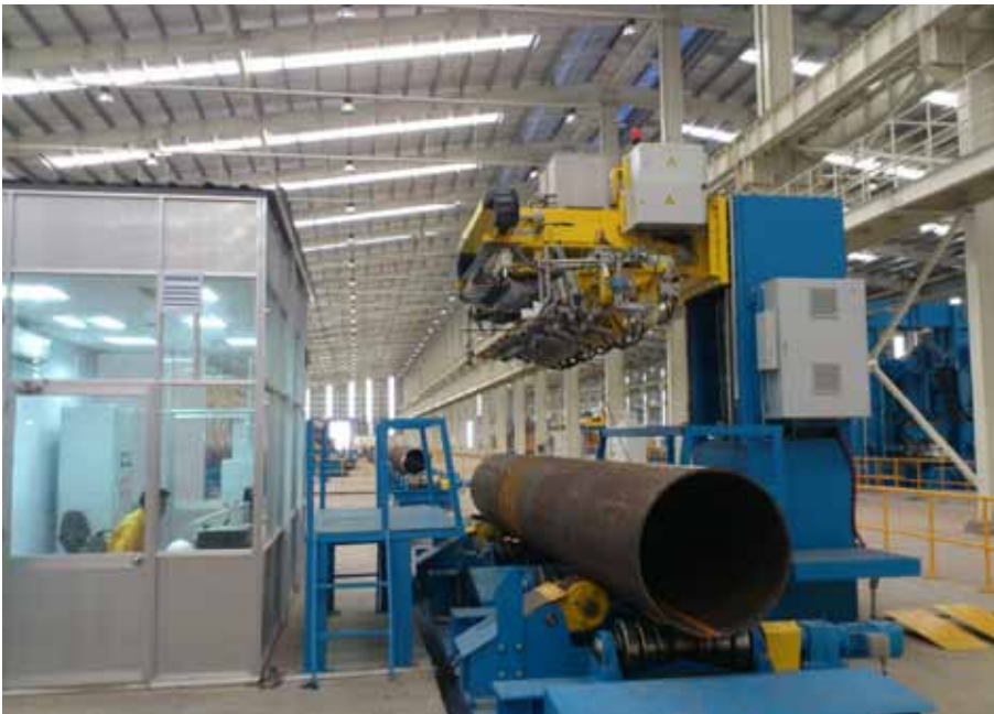
Установка EMATEST-PI для контроля труб большого диаметра с применением фазированных решеток. Компания JSC PV Pipe, Вьетнам, 2011 год
