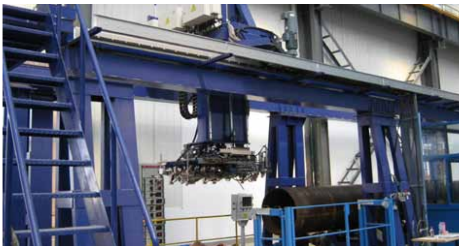
Установка для автоматического ультразвукового контроля труб на заводе в Ялиане, Китай, 2011 год
