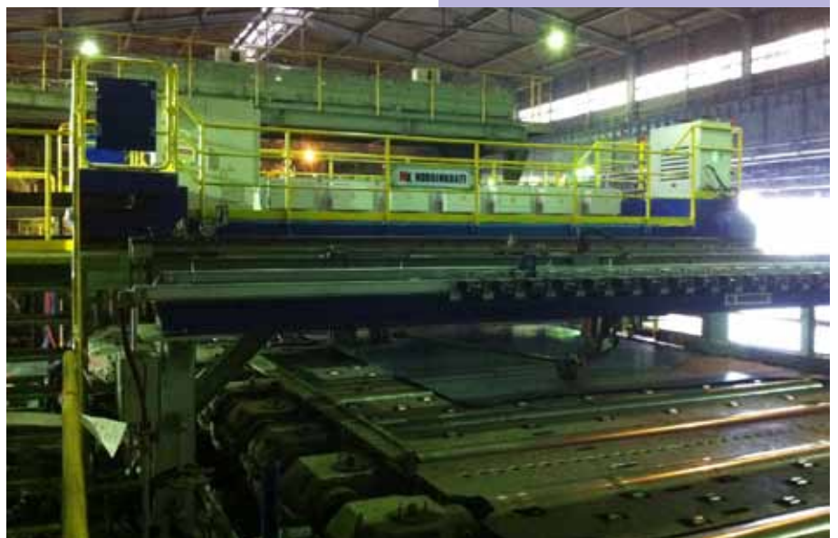
Установка EMATEST-PI-6000 для бесконтактного автоматического ультразвукового контроля листового проката с температурой до +650 °С. Оита, Япония, 2011 год
