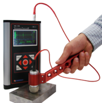
Измерение объектов с высокой температурой поверхности производится при помощи рукоятки
