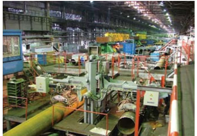
Фиг.16. Установка «Волга-16-002» для ультразвукового контроля прямшовных труб. Две «сдаточные» установки «Волга-16-002» расположены параллельно в составе производственной линии ТЭСА «820» - ОАО «Челябинский трубопрокатный завод», г. Челябинск (Россия).
