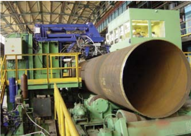
Фиг.15. Установка «Волга-16-002» для ультразвукового контроля спиралешовных труб - ОАО «Волжский трубный завод», г. Волжский (Россия).
