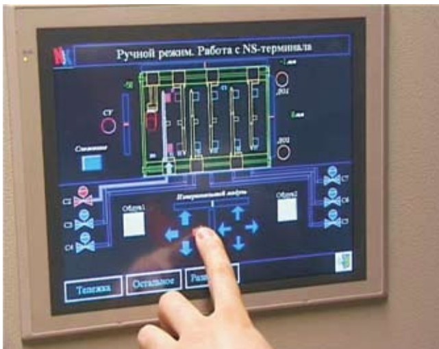
Фиг.19. Панель управления системы автоматизации установки «Волга-16-002».
