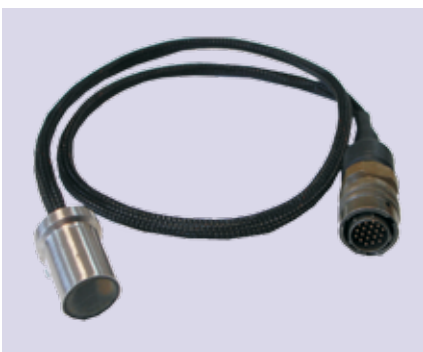
Фиг.3. Пьезоэлектрическая фазированная решетка для контроля сварного шва.
