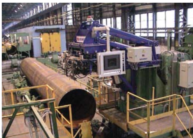
Фиг.14. Установка «Волга-16-002» для ультразвукового контроля спиралешовных труб - ОАО «Волжский трубный завод», г. Волжский (Россия).
