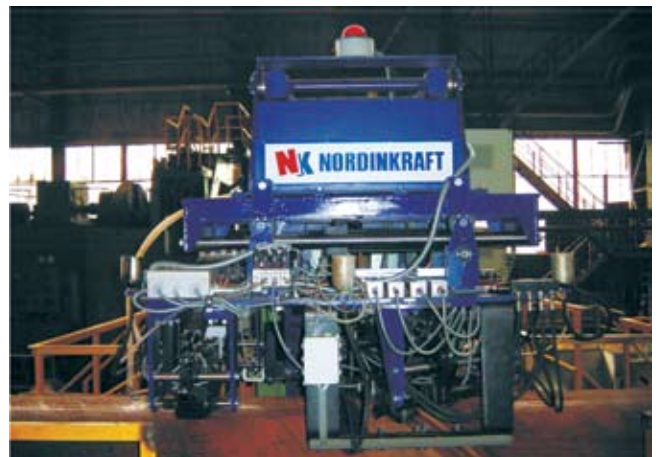
Фиг.18. Измерительный модуль с блоками ЭМАП («бесконтактный» вариант).
