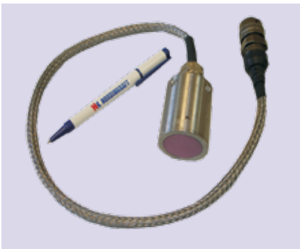
Фиг.2. Электромагнитно-акустический преобразователь для системы контроля швов (СКШ, 1,0 МГц) и для системы контроля концов (СКК, 5,0 МГц).
