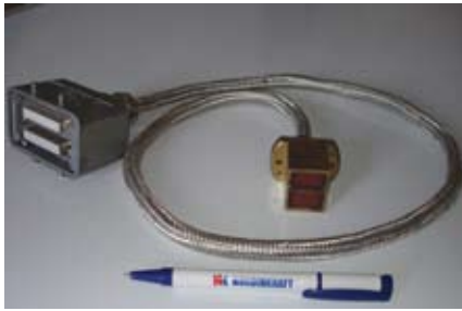
Фиг. 5. Шестнадцатиеlementный раздельно-совмещенный преобразователь – пьезоэлектрическая фазированная решетка (ПФР).
