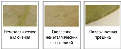
Фиг. 6. Изображение дефектов и осциллограмма сигналов ПФР при секторном сканировании сечения заготовки.
