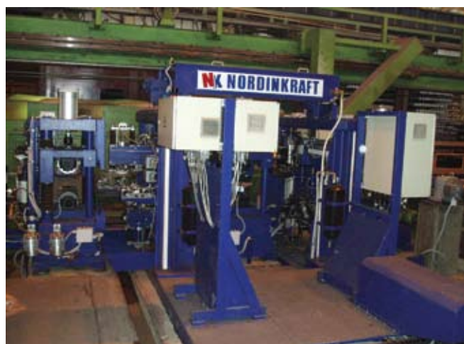
Фиг. 10. Установка автоматического УЗК круглого сортового проката и квадратной заготовки «Волна-7» – СПЦ, РУП «Белорусский металлургический завод», г. Жлобин (Белоруссия).
